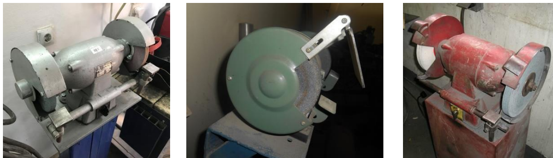
Слика 1 – Примери радионичких брусилца опремљених са заштитним оклопом око тоцила (сопствени извор)
