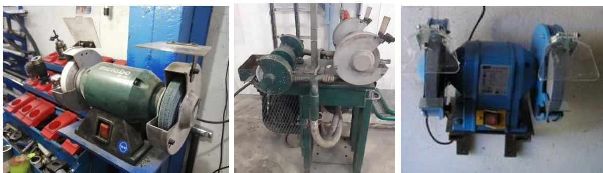
Слика 2 – Примери радионичких брусилца опремљених са заштитним стаклом (сопствени извор)
