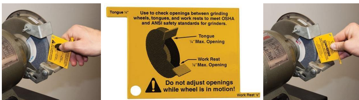
Слика 6 – Провера безбедног растојања између тоцила, радног ослонаца и помичног заштитног језичка [14]
