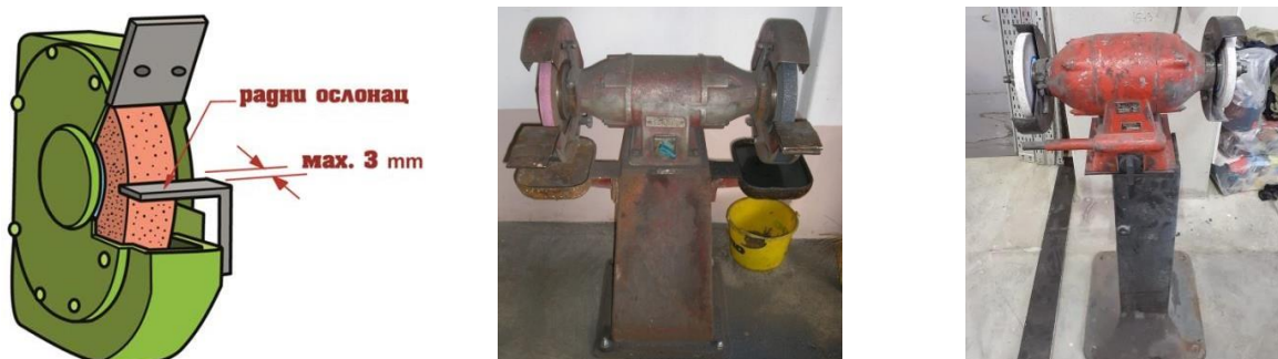
Слика 4 – Примери радионичких брусилица са радним ослонцем (сопствени извор)
