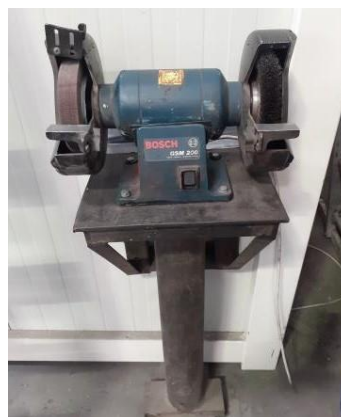
Слика 5 – Правилно подешен радни ослонац у односу на тоцило (сопствени извор)
