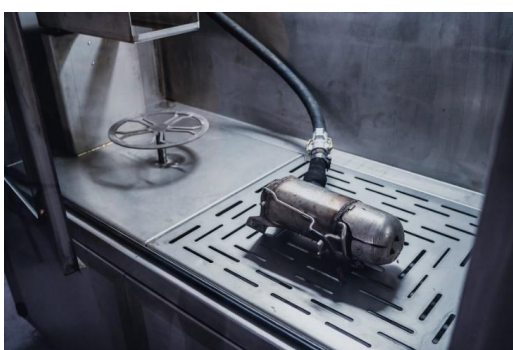
Слика 5 - Тестирање DPF филтера пре регенерације
