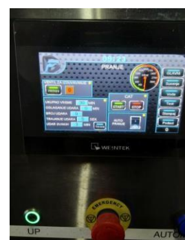
Слика 7 - Тач панел, приказ пре регенерације
